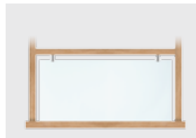
Soubassement en tôle perforée entre 2 lisses métal
